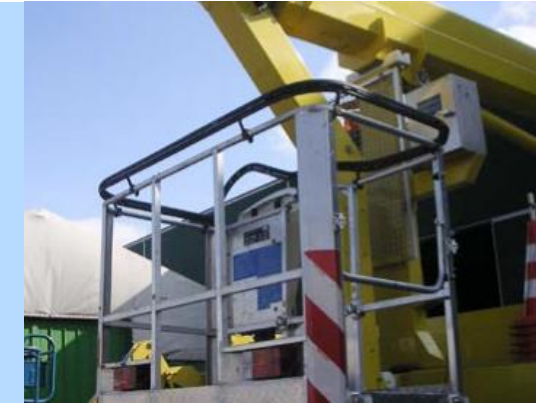
Abschalleiste gegen Quetschgefahren
